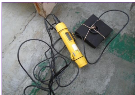
ภาพที่ 3.2.5-4 การตรวจวัดความเร็วและทิศทางการไหลของกระแสน้ำ
